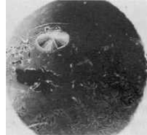
Abb. 16. Seewasser mit vielen verschiedenen Mineralien. Sekundärkristallisation rund um die scheibenförmigen CaCO_3 -Kristalle. 400
