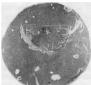
Abb. 18. Halbscheibe (am Tropfenrand), 1 Woche alt. Einen Teil des \text{CaCO}_3 verwandelte sich in nadelförmige Kristalle. 1000
