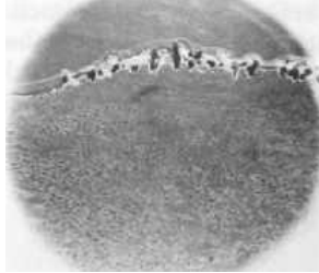
Abb. 7. Leitungswasser einer Privatwohnung vor der Anbringung der Behandlungsvorrichtung. Rand ist dicht bedeckt mit schwerem, prismatischen CaCO 3 -
