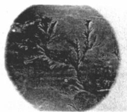
Abb. 9. Wasser im Kühlturm eines Krankenhauses, enthält Algizide und Bakterizide, Verästelungen beginnen die Fläche zu bedecken. 200
