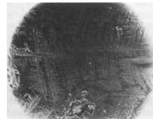
Abb. 1a. Massive \text{CaCO}_3 -Kristalle, starke prismatische Polarisation und Bündel von nadelförmigen Kristallen. 400
